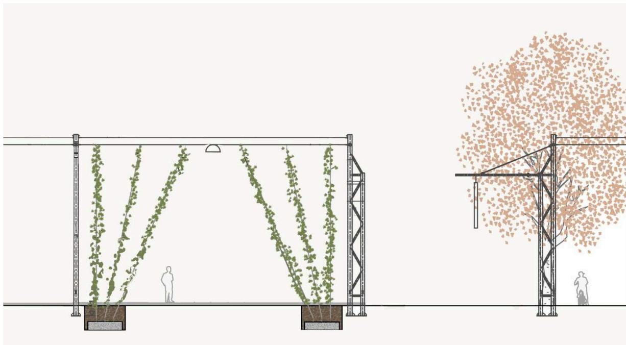
**Figura 1- (schema tipo installazione verde rampicante combinato alla tesata della PI)**
